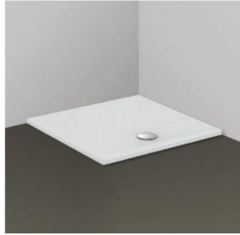
Piatto doccia quadrato in ceramica. Disponibile con trattamento antiscivolo Ideal Grip (conforme alle normative DIN51097 - Classe B, EN14516/14517) su tutta la serie. Per installazione sopra o filo pavimento. Foro di scarico Ø90 mm. Piletta sifonata da ordinare separatamente.
