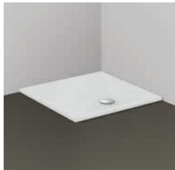
Piatto doccia quadrato in ceramica. Disponibile con trattamento antiscivolo Ideal Grip (conforme alle normative DIN51097 - Classe B, EN14516/14517) su tutta la serie. Per installazione sopra o filo pavimento. Foro di scarico Ø90 mm. Piletta sifonata da ordinare separatamente.
